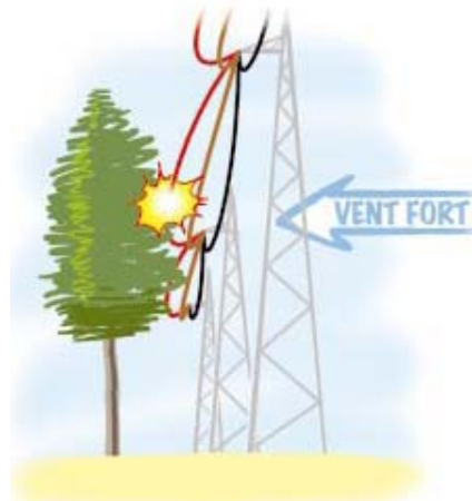
Le vent rapproche le câble électrique de la végétation. Au moment du contact, la végétation fait masse et l'énergie électrique est dissipée le long de l'arbre ; cela suffit à provoquer un début d'incendie
